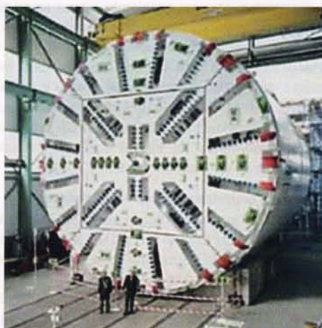
Slika 6. Pogled na poprečni presjek tunela za osobna vozila (tunnel est) i rotacioni bušeći stroj za iskop tunela na autocesti A86[9]
