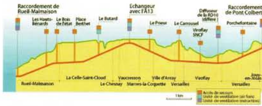
Slika 11. Uzdužni presjek trase tunela s funkcijom vertikalnih šahtova kao: sigurnosnih izlaza (narančasto), ventilacionih otvora za dovod svježeg zraka (sv.plavo) ili ventilacionih otvora za otpremu korištenog zraka (ljubičasto)
