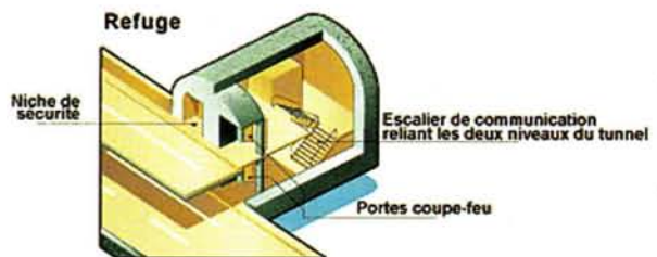
Slika 15. Pogled na 3D presjek sigurnosne niše i vezu na obje etaže cestovnog tunela
