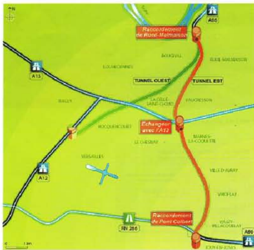
Slika 2. Položaj istočnog tunela za teretna vozila (tunnel ouest) i zapadnog tunela na dvije etaže za osobna vozila (tunnel est) na autocesti A86[10]
