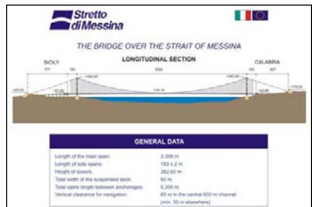
Sl.33 Most Messina : uzdužna dispozicija mosta s osnovnim geometrijskim podacima, Italija.
