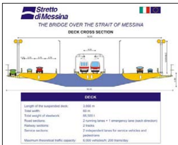
SI.34 Most Messina : pogled na poprečni presjek visećeg mosta. Italija.
