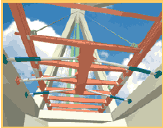
SI.40 Most Rion Antirion : pogled na konstrukciju spregnutog kolovoznog nosača s sirinom od 27.2 m.
