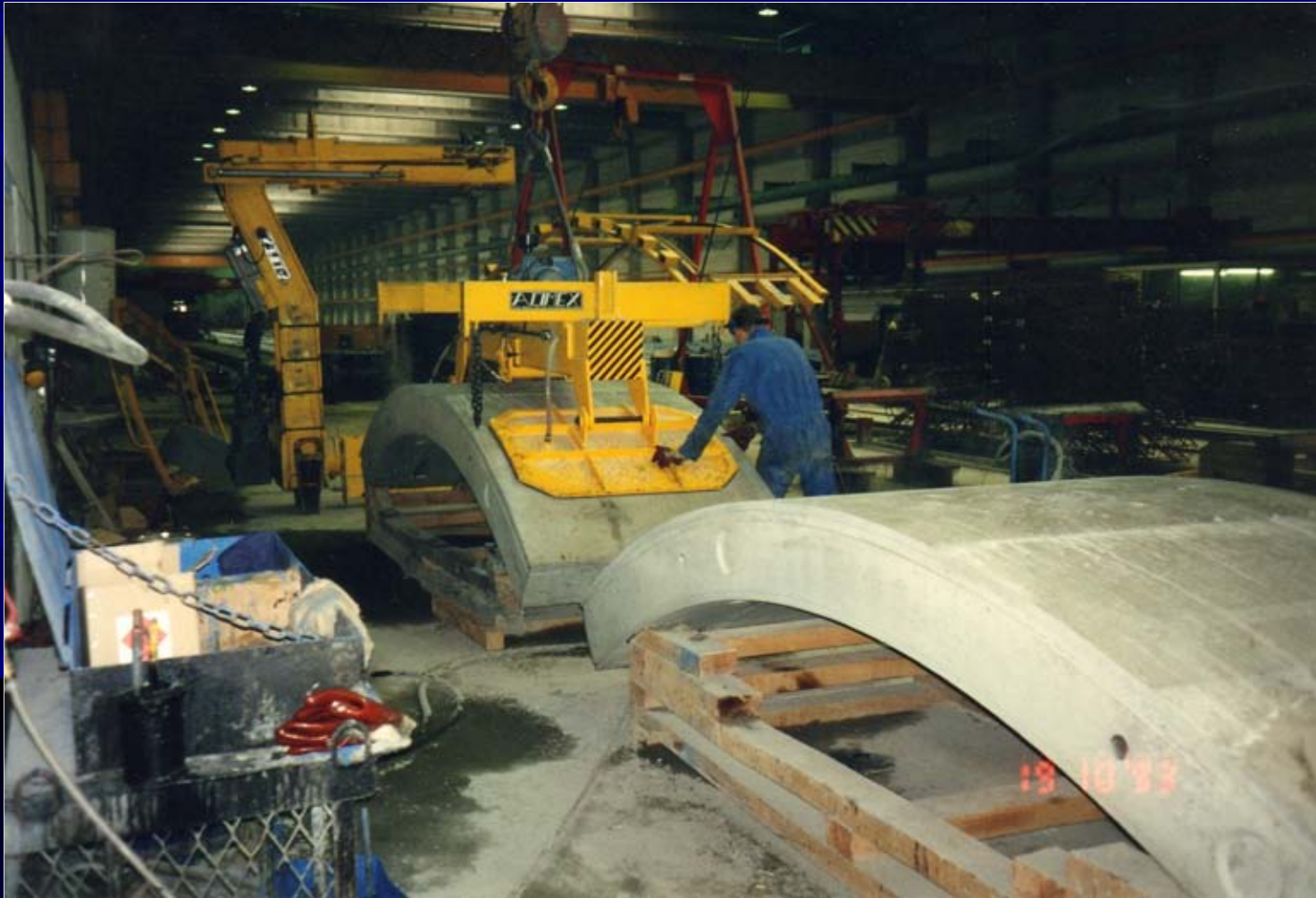
Linije R.E.R. "E" , sekcija 35B u centru Pariza Tvornica elemenata segmentne AB obloge tunela : vakuum kran Str. 9/ 20
